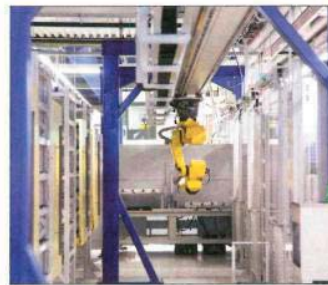
Das neue Schwanog Erodierzentrum mit neun Erodierzentren in einer Roboterzelle
